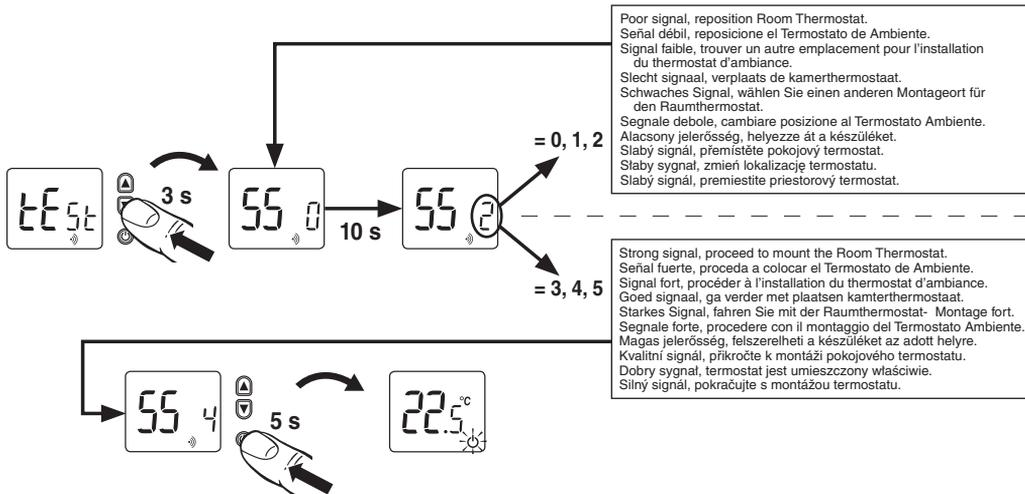
**3.5** **GB** Mounting the Room Thermostat **E** Colocación del Termostato de Ambiente
